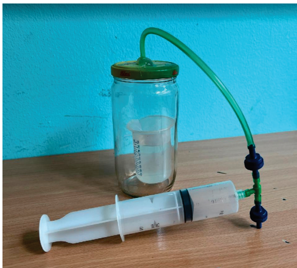
Obr. 5. Vaření vody ve vývěvě vyrobené ze zavařovací sklenice
